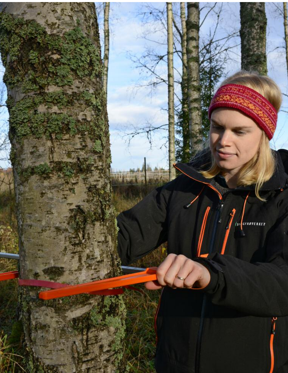
Jobben i Skogfrøverket gir Birgit en fin faglig kombinasjon for fagene plantevitenskap og skogfag, som hun har studert ved NMBU. Her er hun ute med en god gammeldags klave for å måle treets volum.
