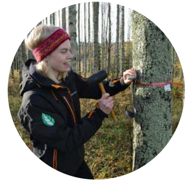
Birgit gjør mye forsøksarbeid i skogen. Her er hun ute med en fiberhelningsmåler for å se hvordan trefiberne i dette treet er.
