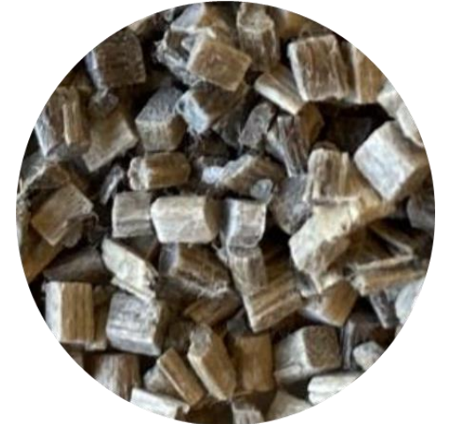
NorFill granulat etter 8 år i testkasse
