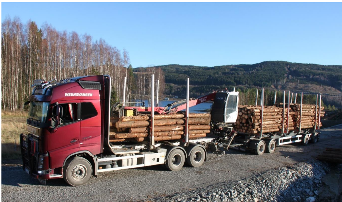
Bilde 1 Tømmervogt med langhenger lastet etter bruksklasse T8 med 50 tonn totalvekt
