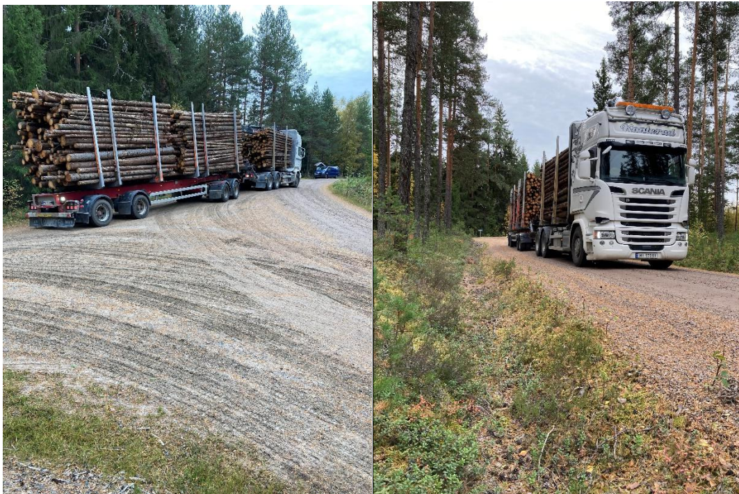
Figur 8. Snuing (rygging) av 60 tonn vogntog på søndre ende av parsell (venstre) og ut på ny runde (høyre). En tur/returrunde inkludert 2 vendinger tok ca 8 minutter for dette vogntoget. (Foto: Jan Bjerketvedt)
